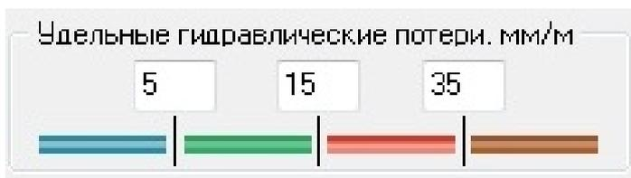
1. Участки теплопроводов окрашенные в синий цвет являются хорошо проводящими (удельные гидравлические потери до 5 мм/м).
